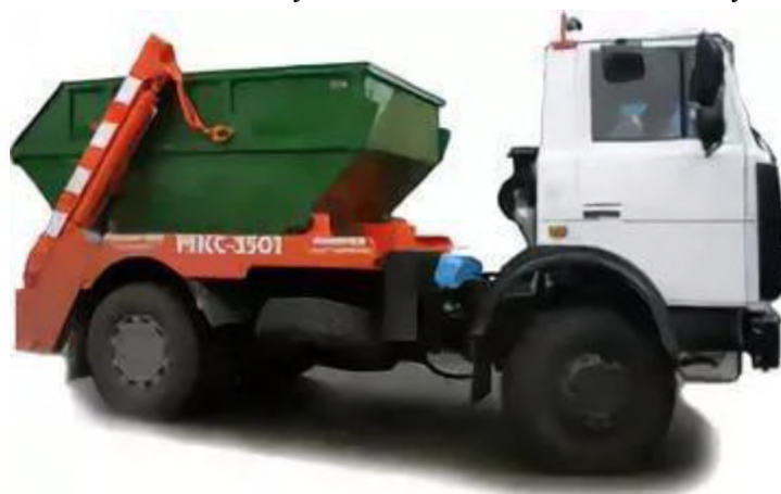
Рисунок 5.25. Бункеровоз МКС-3501 на шасси МАЗ-5551А2.
