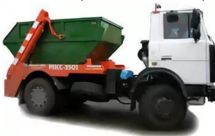
Рисунок 5.25. Бункеровоз МКС-3501 на шасси МАЗ-5551А2.
