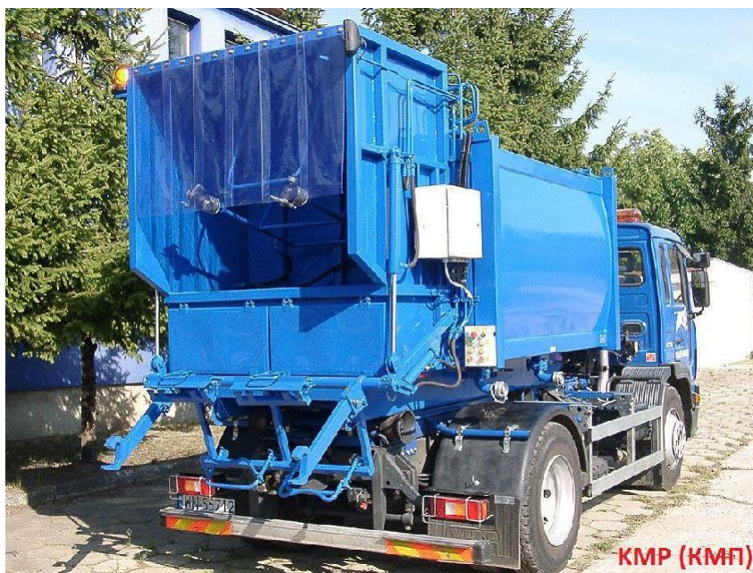
Рисунок 5.16. Спецмашина для мойки контейнеров Haller.
