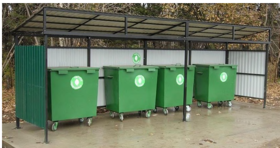
Рисунок 5.14. Контейнерная площадка с навесом на 4 контейнера.
