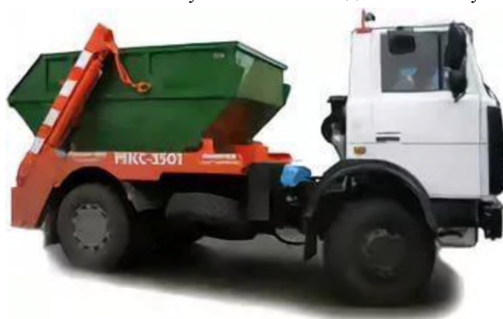
Рисунок 5.25. Бункеровоз МКС-3501 на шасси МАЗ-5551А2.
