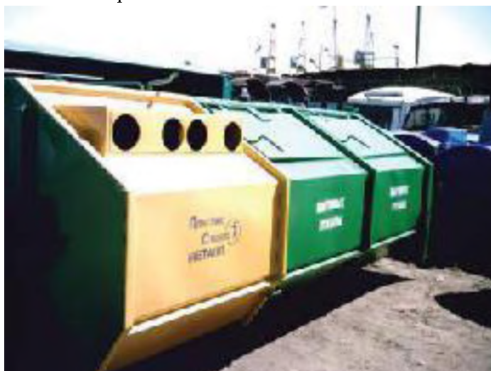
Рисунок 5.6. Совмещенный контейнер для селективно собранных и обычных отходов.
