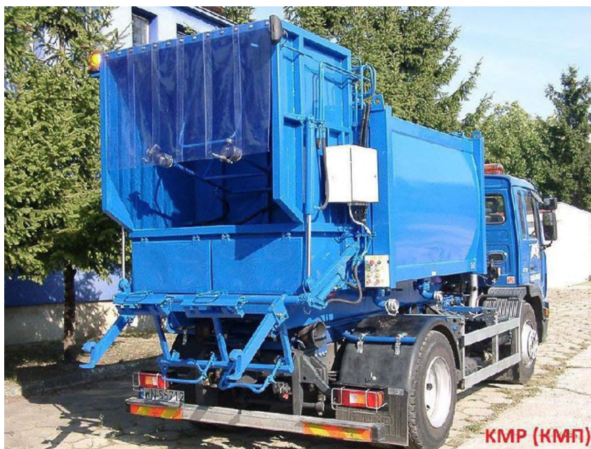
Рисунок 5.16. Спецмашина для мойки контейнеров Haller.
